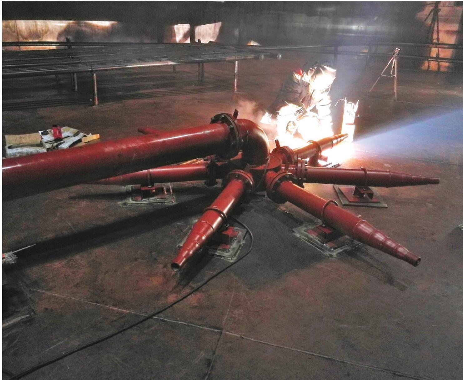
На объект установки устройство доставляется в разобранном виде с комплектом монтажных частей и опор для крепления устройства.
