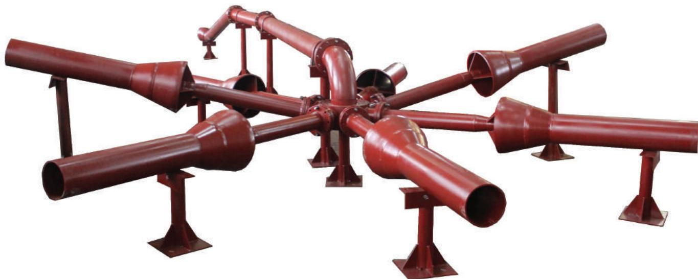
**Вывод:** УПС придаёт достаточную однородность смеси, применение устройства на резервуарах, используемых для хранения высоковязких продуктов, целесообразно.
